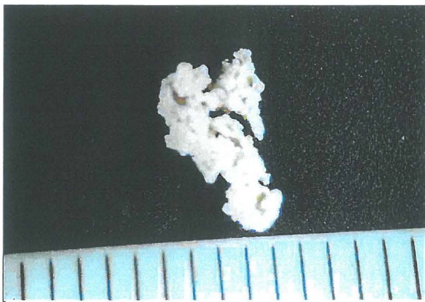
Abbildung 6 Mikroskopische Aufnahme einer "Hedulit"-Granula
