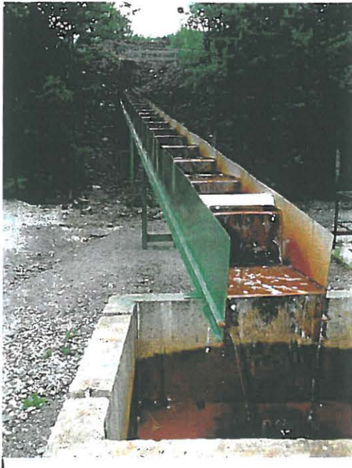
Abbildung 1 Belüftungskaskade der Pilotanlage zur passiv/biologischen Behandlung des Flutungswassers der Grube Pöhla-Tellerhäuser
